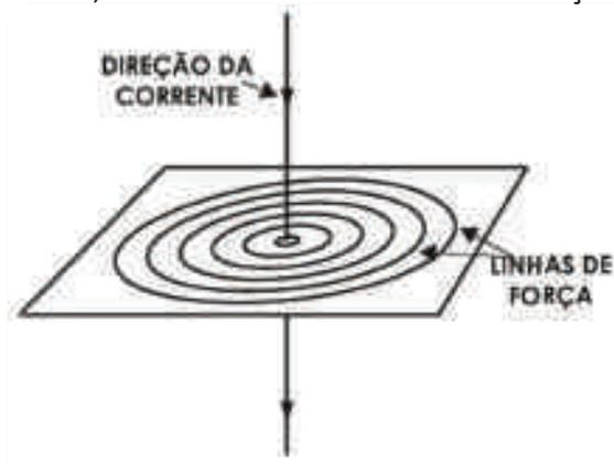
Fig. 4: Campo magnético provocado pela corrente elétrica
