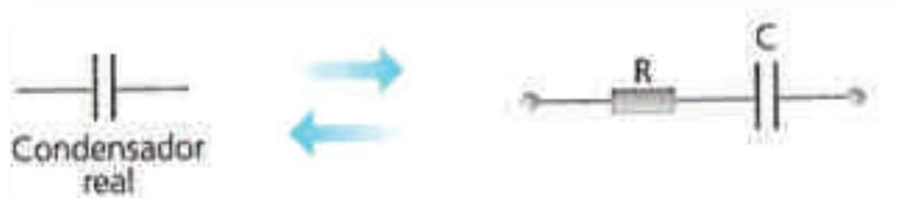
Fig. 27: Condensador real e circuito equivalente
