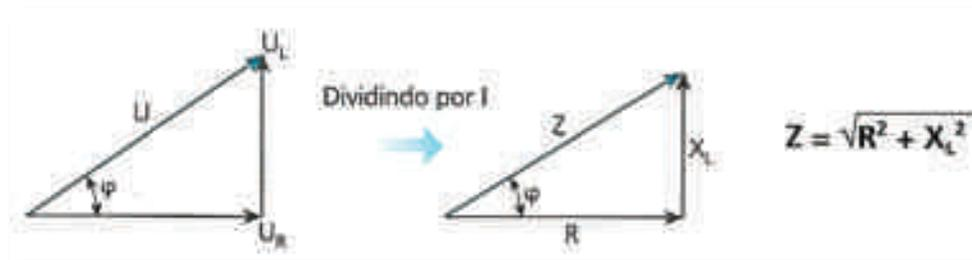
Fig. 26: Triângulo das tensões e das impedâncias
