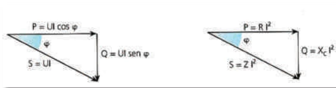
Fig. 38: Triângulo das potências num circuito RC
