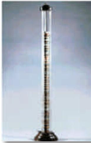
*Fig. 3: Pilha de Volta*
